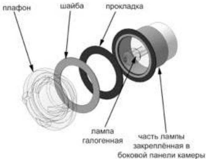
Рисунок 3. Составные элементы галогенной лампы круглого типа крепления
