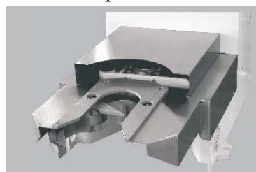
Узел фиксации и привода вращения дежи
