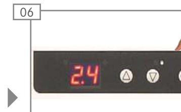
Выключите блок охлаждения, если он не используется. После выключения оставьте приоткрытой дверцу блока охлаждения, чтобы предотвратить появление запаха внутри.
