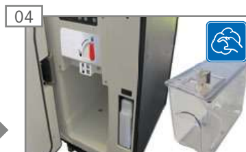
Произведите очистку емкости для молока, деталей молочной системы и камеры охлаждения.
