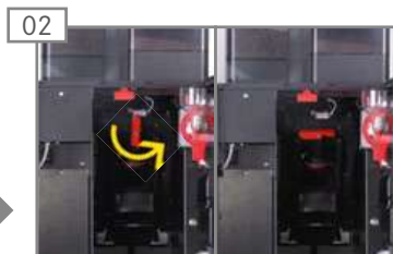
Разблокируйте заварочный блок поворотом блокировочного элемента против часовой стрелки.
