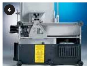
1 - Paramano piatto in plexiglass Plexiglass hand guard 2 - Elsa su manopola pressamerce Grip on the meat press knob 3 - Microinterruttore su paralama Micro on blade cover 4 - Protezione inferiore Underside motor protection plate
